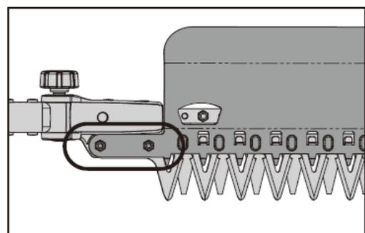
④固定刃取付ネジ・ナット2か所を取り付ける
